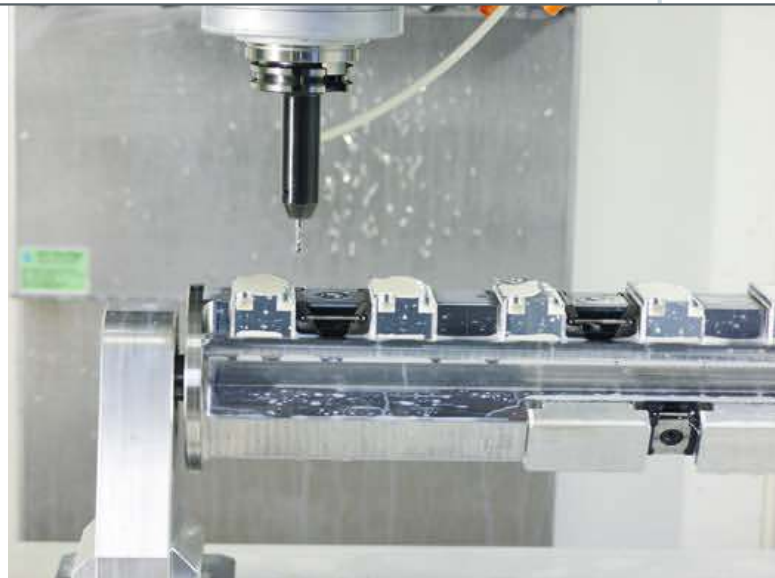
3 Bauteil aus einer Aluminiumlegierung, das in Beatmungsgeräten eingesetzt wird. Schweiher stellt den Rohling komplett mit Eroglu-Aufnahmen her
