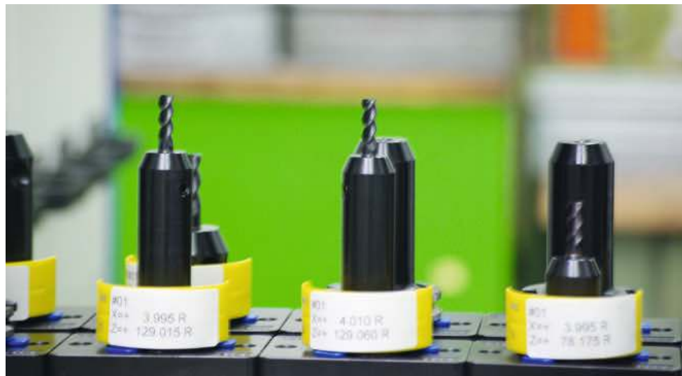
1 Zentraler Pool aus 1200 Komplettwerkzeugen, auf die von elf Maschinen zugegriffen wird
